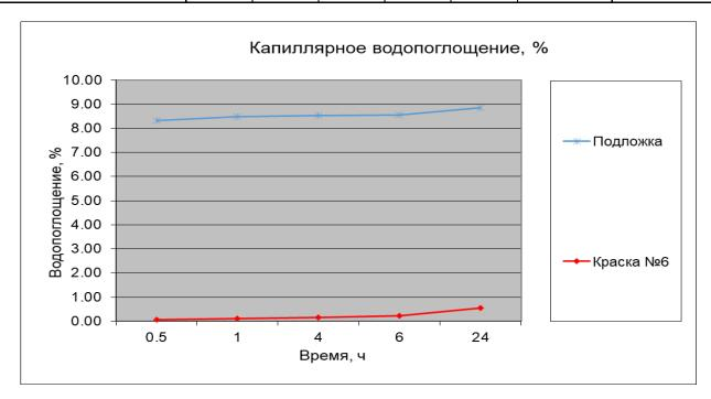
Рис. 1. Кинетика капиллярного водопоглощения образцов красок
